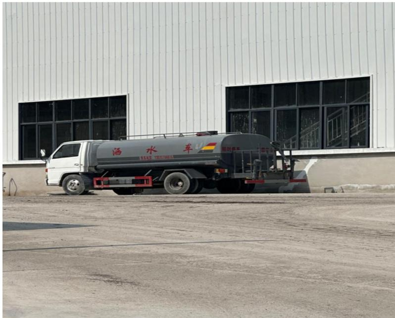
图 4-3 洒水车喷淋抑尘
