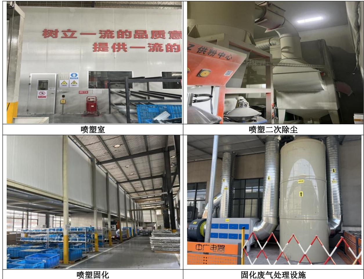
图 3-6 喷塑废气产污结点和处理设施现场图
