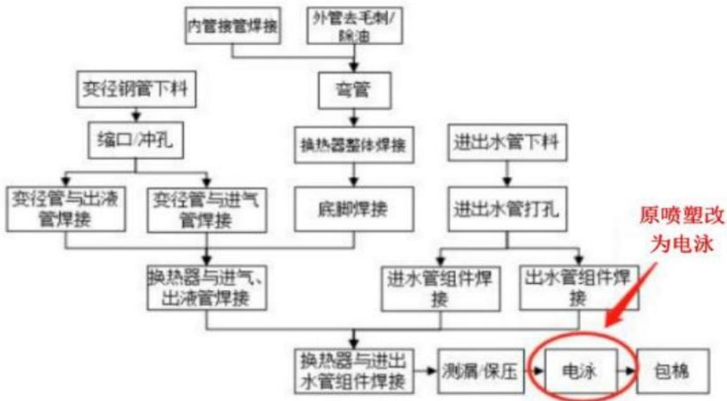
图 2-11 套环换热器生产工艺
