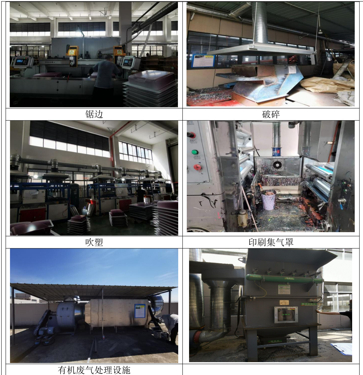
图 3-1 废气产污结点和处理设施
