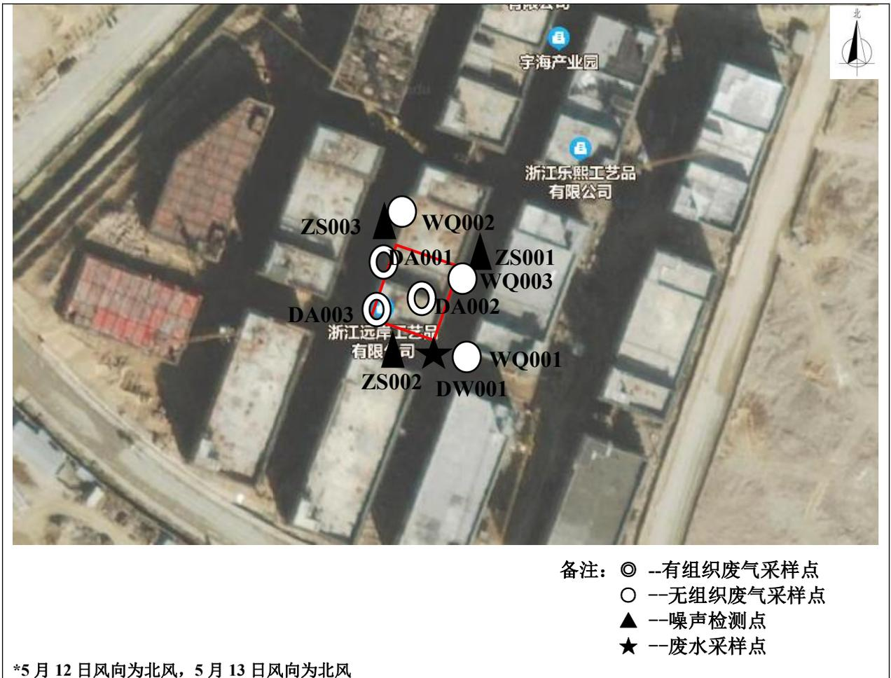
图 3-4 废水、废气、噪声监测点位示意图
