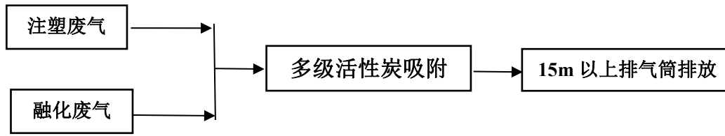
图 4-1 项目废气防治措施
