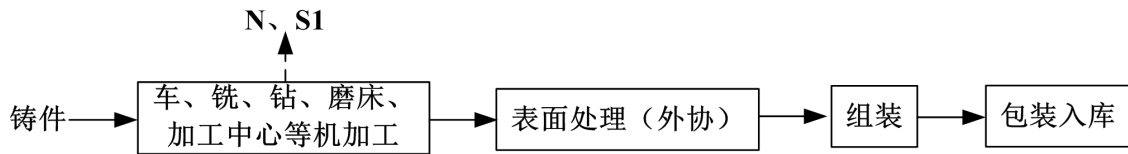
图 2-2 固定座、支撑座、传动座生产工艺流程及产污环节图
