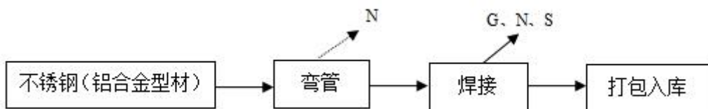
图 2-4 不锈钢（铝合金）栏杆生产工艺流程图
