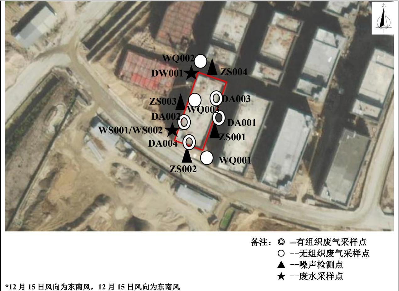
图 3-4 废水、废气、噪声监测点位示意图
