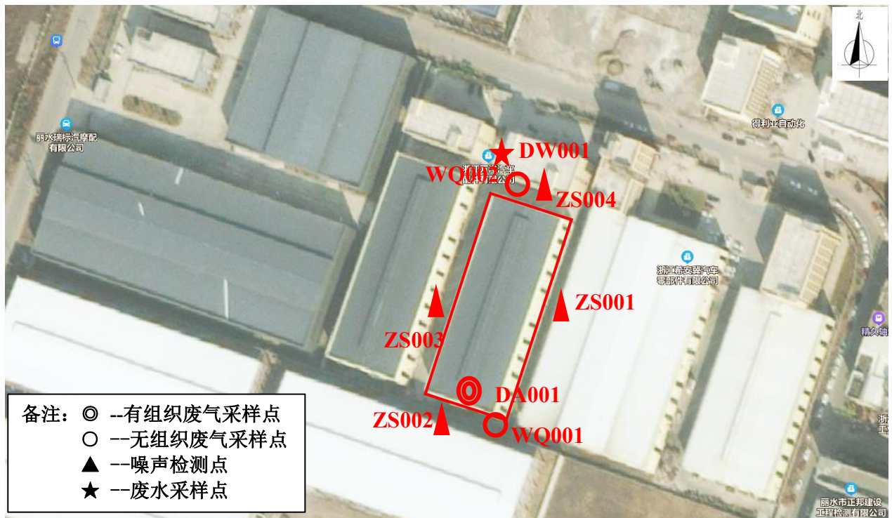
图 3-2 废水、废气、噪声监测点位示意图
