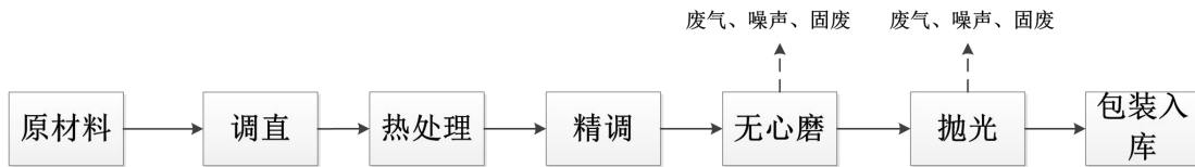
图 2-2 直线光轴生产工艺流程图
