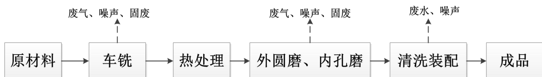
图 2-7 轴承生产工艺流程图
