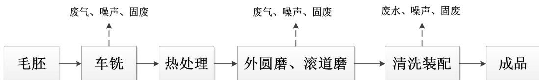
图 2-6 丝杆螺母生产工艺流程图
