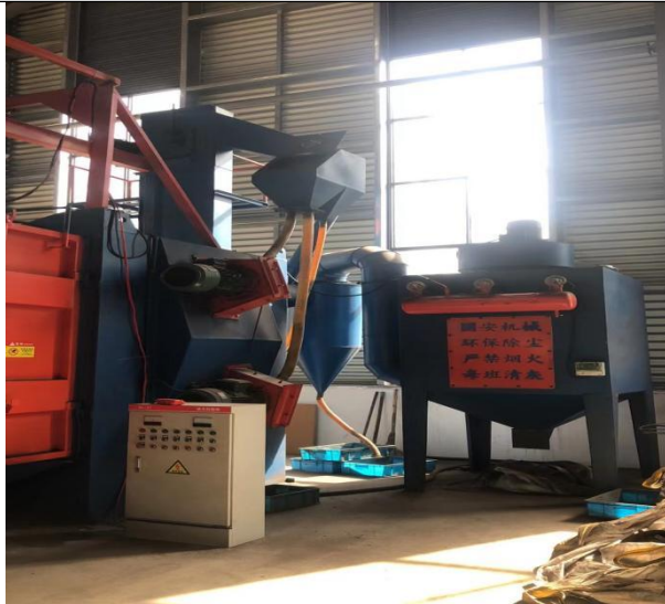
抛丸机和除尘设施
