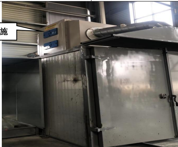
烘箱及废气处理设施
