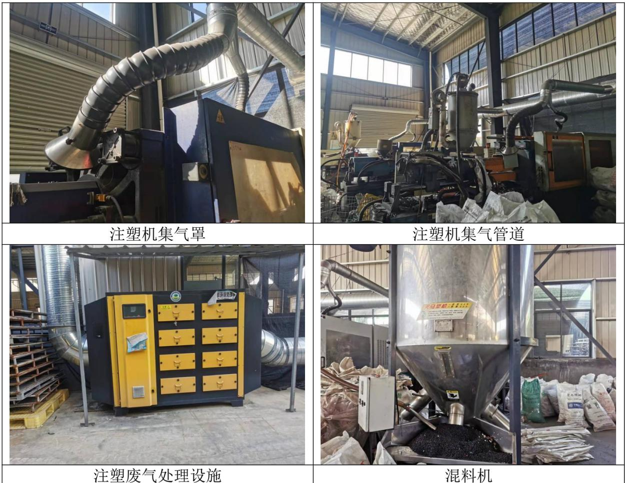
图 3-2 废气产污节点和除尘设施现场图
