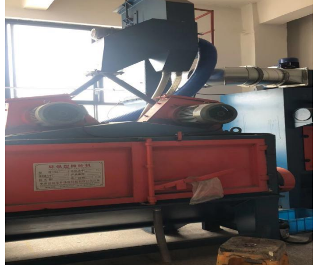
抛砂设施及除尘器
