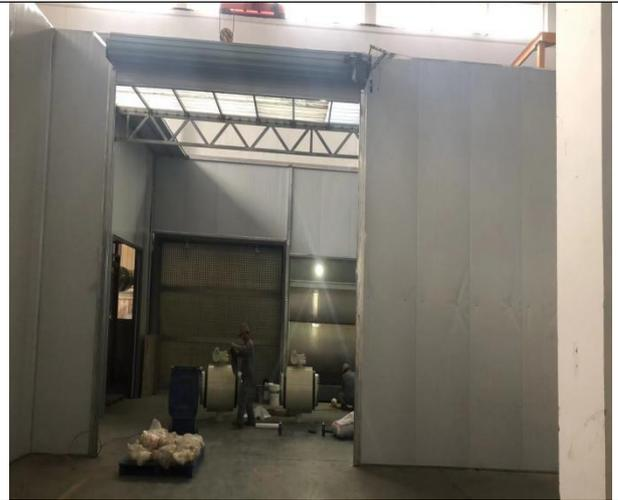
大型阀件喷漆加工区
