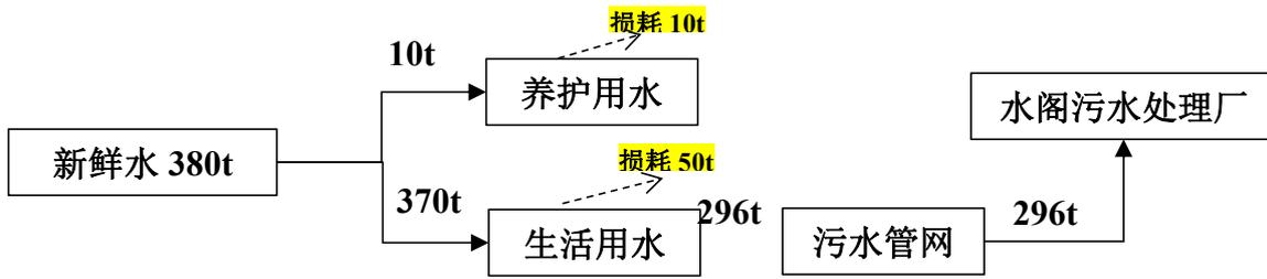
图 2-5 水平衡示意图
