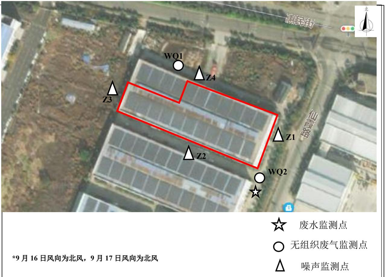
图 3-2 废水、废气、噪声监测点位示意图
