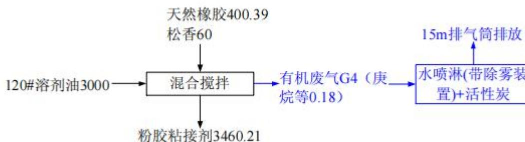
图 4-4 粉胶粘接剂生产工艺流程图示意图
