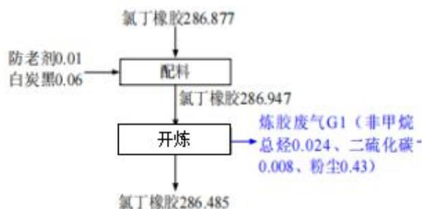
图 4-1 炼胶工艺流程示意图
