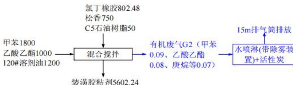
图 4-2 装潢胶黏剂生产工艺流程图示意图
