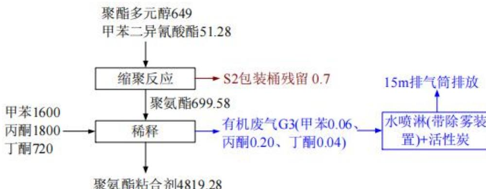
图 4-3 聚氨酯粘合剂生产工艺流程图示意图
