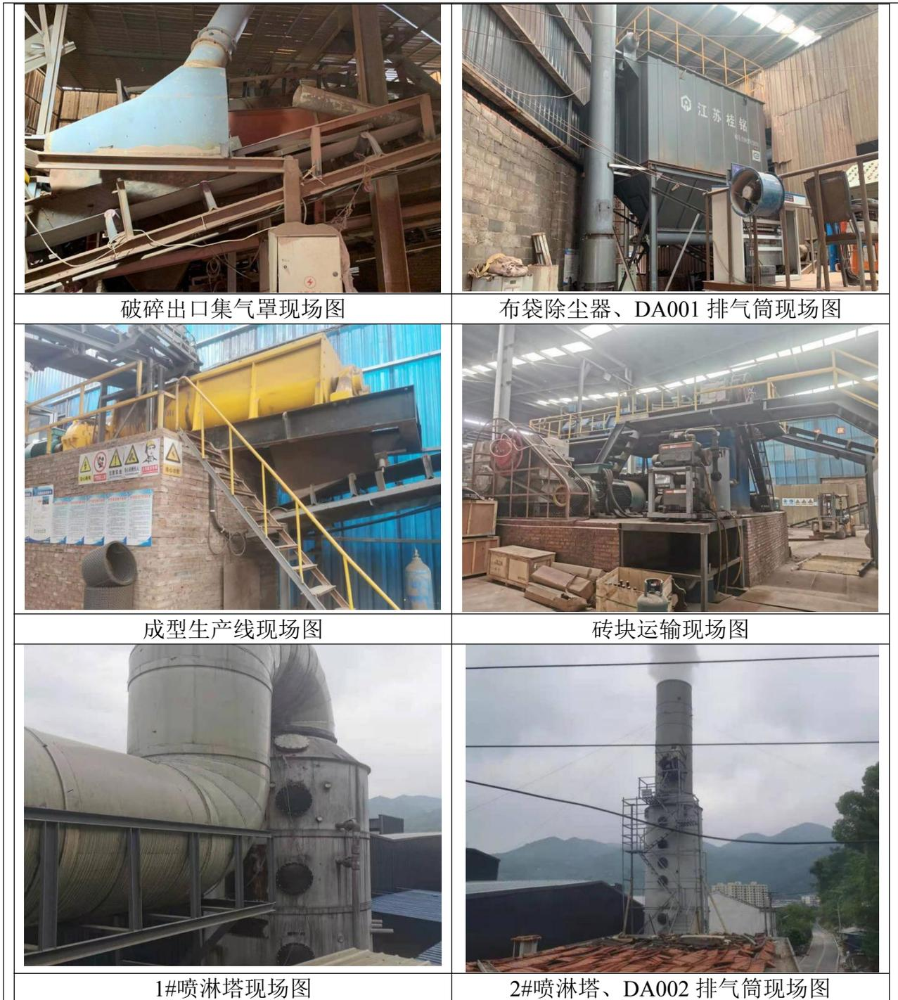
图 3-3 废气产污节点和处理设施现场图
