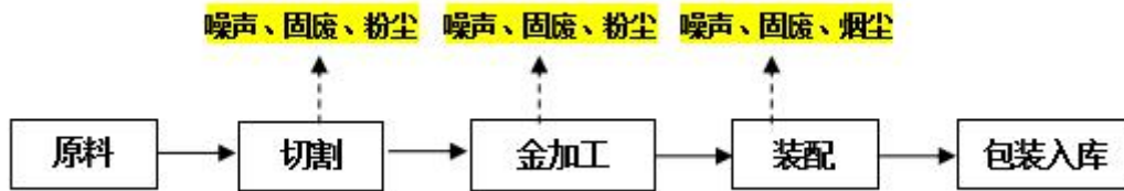
图 3-6 绝缘子生产工艺流程图
