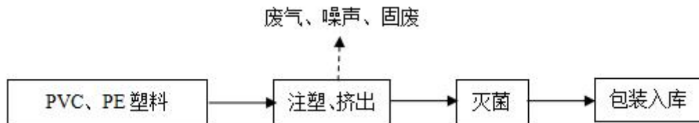
图 3-5 耗材生产工艺流程图
