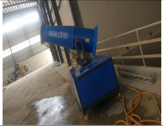
破碎车间外喷雾炮
