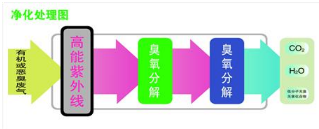
图 4-4 废气处理工艺流程图
