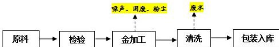
图 3-4 法兰工艺流程图
