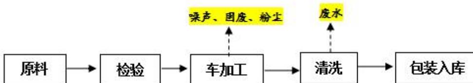
图 3-5 阀门工艺流程图
