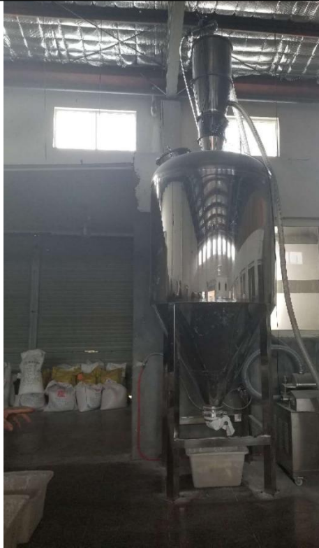
搅拌机现场图
